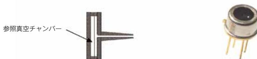
図3 絶対圧センサの測定原理
